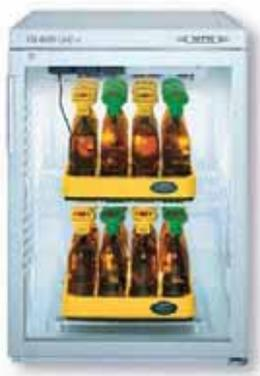
WTW的培养箱可以为BOD分析提供生物培养所需的恒定温度，温度在 $10\text{--}40^{\circ}\text{C}$ 范围之间可设，精度为 $1^{\circ}\text{C}$ ，由于在五天培养过程中需要搅拌，因此每种培养箱内都标准配备了2-4个电源插座。根据所需测试的BOD数量，有多种容量的培养箱供用户选择，从2层到4层都有，即用户只需一台培养箱最多可同时分析48个样品。另外还有一款TS1006特大型培养箱，尺寸足够1.5升大容量BOD培养瓶安放在里面，最多有4层。在培养过程中，为达到最佳精度，应该尽量避免频繁打开培养箱的门，此时只要选择WTW遥控BOD测试系统OxiTop Control再选配透明玻璃门的培养箱就可实现这一目标。
