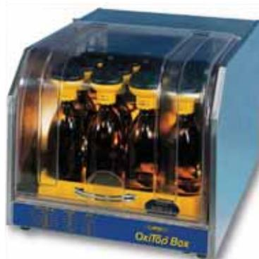
OxiTop Box培养箱控制精度高，温度 $20^{\circ}\text{C}\pm 0.5^{\circ}\text{C}$ 。带透明玻璃门，非常适合遥控BOD测试仪OxiTop Control系列使用。另外也用于常规经典BOD稀释测试法，可装20个BOD培养瓶。培养箱用耐腐蚀材料制成，不含氟里昂。特制风扇使箱内温度分布更加均匀，另外还有自动除霜防冻功能。
